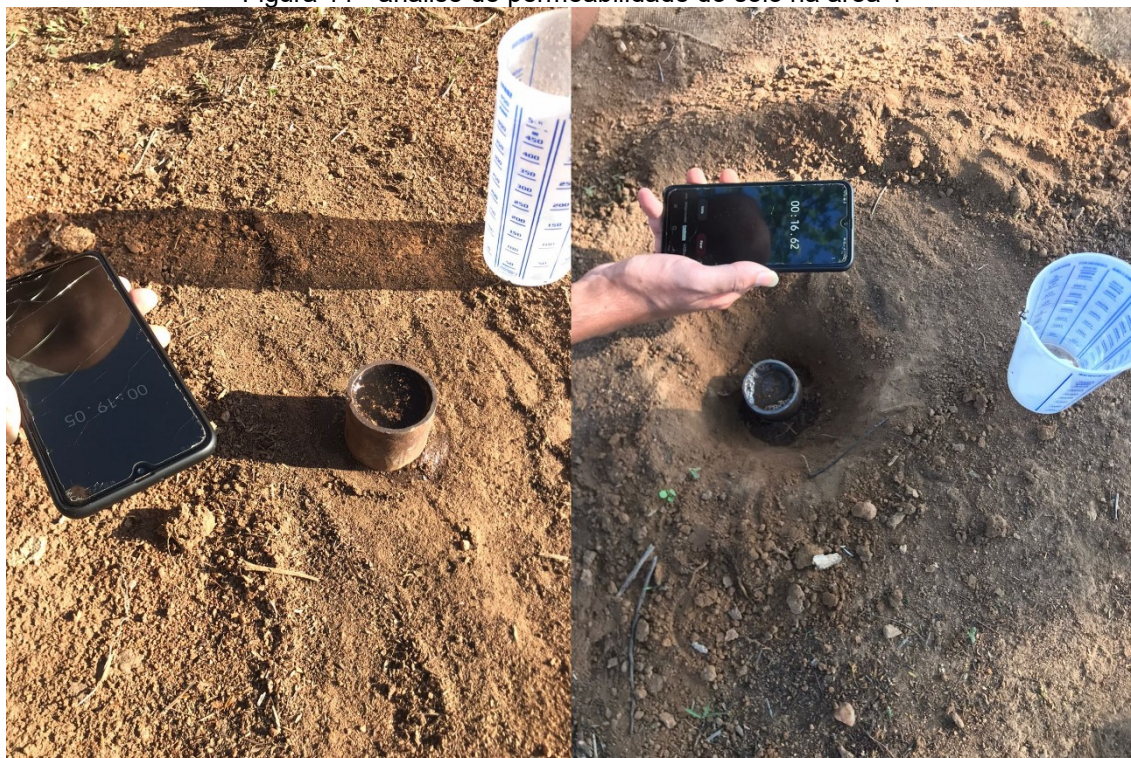
Figura 11 - análise de permeabilidade do solo na área 1
