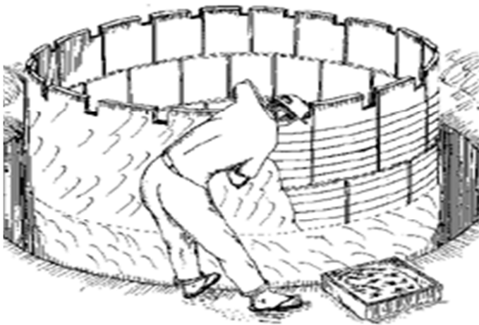
Figura 1. Construção da cisterna (Montagem e revestimento).
