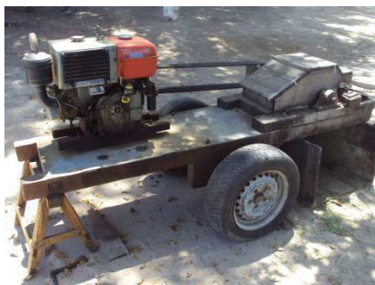
Figura 1. Máquina “Paraibana” utilizada no processo de desfibramento das folhas de sisal.
