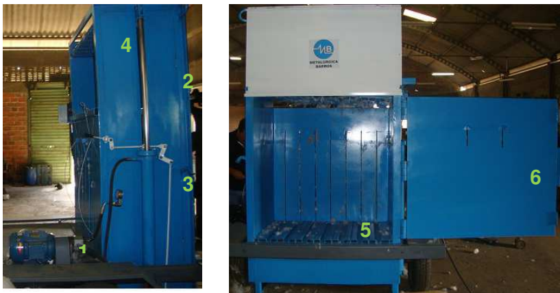
Figura 4. Foto da prensa enfardadeira com os principais componentes. 1 - motor elétrico com bomba hidráulica; 2 - êmbolo ou pistão do cilindro hidráulico; 3 - camisa do cilindro hidráulico; 4 - chapa de prensagem móvel; 5 - chapa de prensagem fixa; 6 - porta para retirada do fardo.
