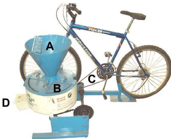
Figura 8. Componentes do descascador de frutos de R. communis : Alimentador (A); sistema de descascamento - discos (B); sistema de acionamento - pedal de bicicleta (C); e descarga do material descascado (D).
