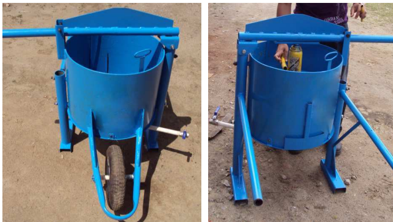
Figura 3. Prensa Hidráulica de acionamento manual (A). Detalhe do macaco hidráulico sendo acionado para extração do suco (B).
