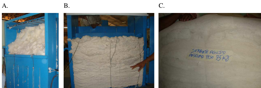
Figura 6. Fotos sequenciando a formação do fardo de algodão pela prensa enfardadeira. (A) Alimentação e prensagem. (B) Amarração do fardo. (C) Pesagem e identificação do fardo.
