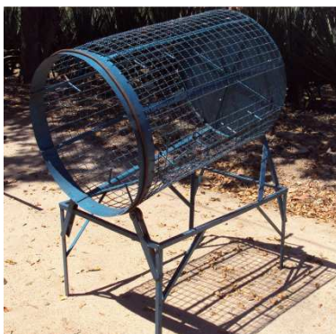
Figura 4. Peneira Rotativa de acionamento manual, desenvolvida pela Embrapa Algodão, utilizada para separação da bucha e da mucilagem do resíduo do desfibramento das folhas de sisal.
