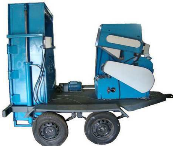
Figura 8. Configuração final do conjunto descaroçador e prensa enfardadeira itinerante.
