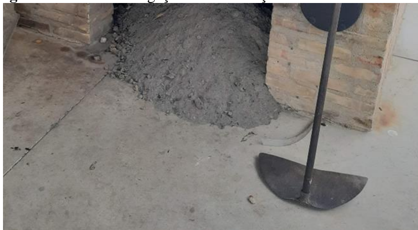
Figura 12: Cinza do bagaço da cana de açúcar no fundo da caldeira
