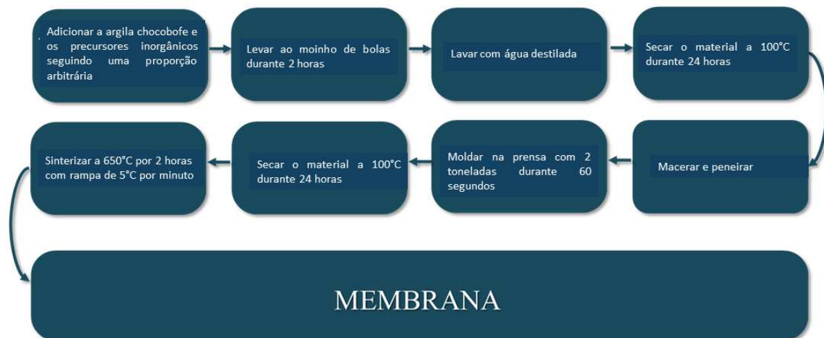
Figura 9 – Diagrama de preparação das membranas cerâmicas de baixo custo.
