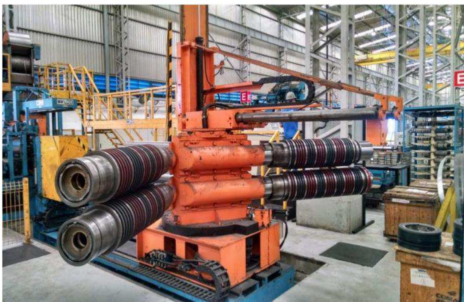
Figura 3 - Cabeçote de troca rápida para tesouras rotativas. Fonte: Empresa pesquisada (2014).
