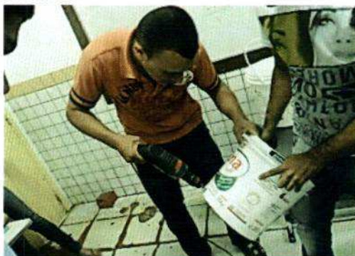
Figura 35 – Balde sendo furado para inserção de torneira para coleta de chorume.
