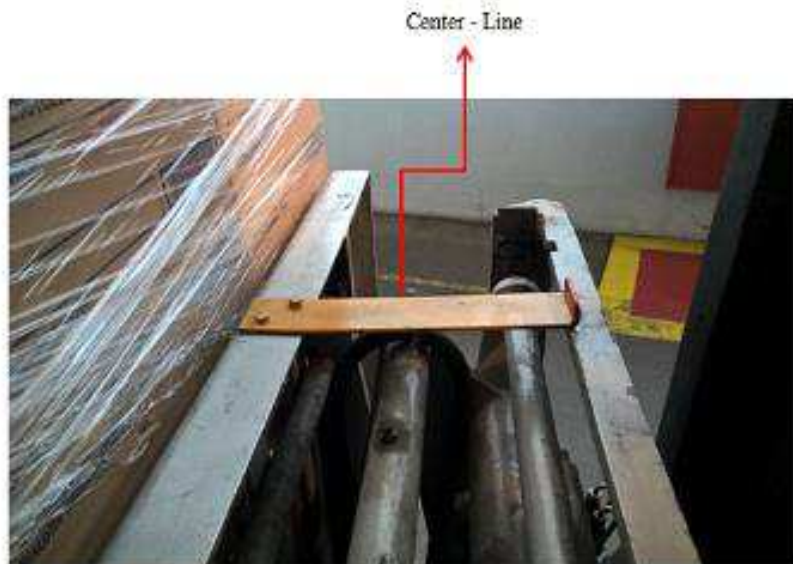
Figura 7 - Center line : Posição correta do equipamento
