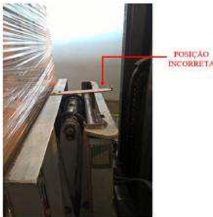
Figura 6 - Forma incorreta do Center line
