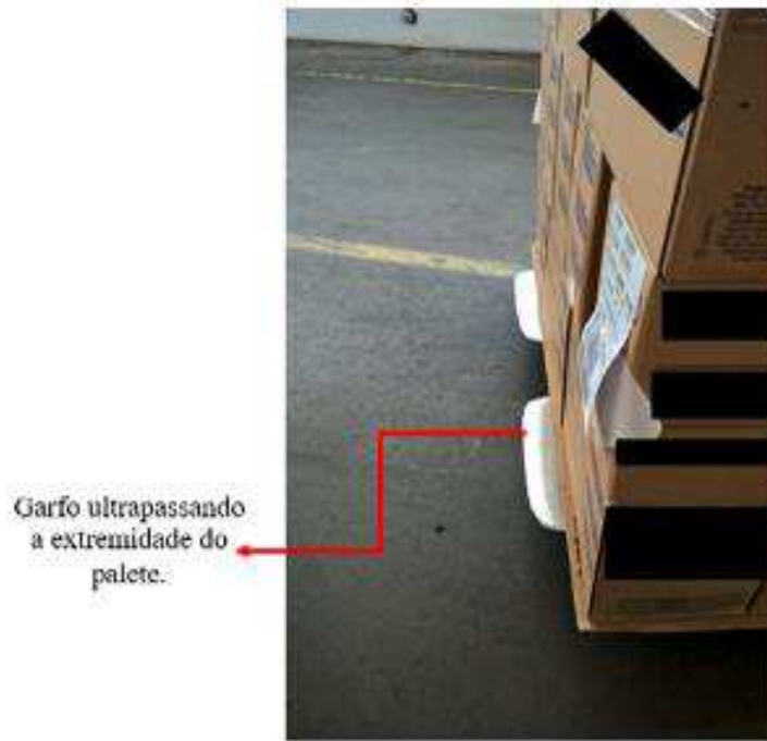
Figura 9 - Garfo da empilhadeira ultrapassando a extremidade do palete
