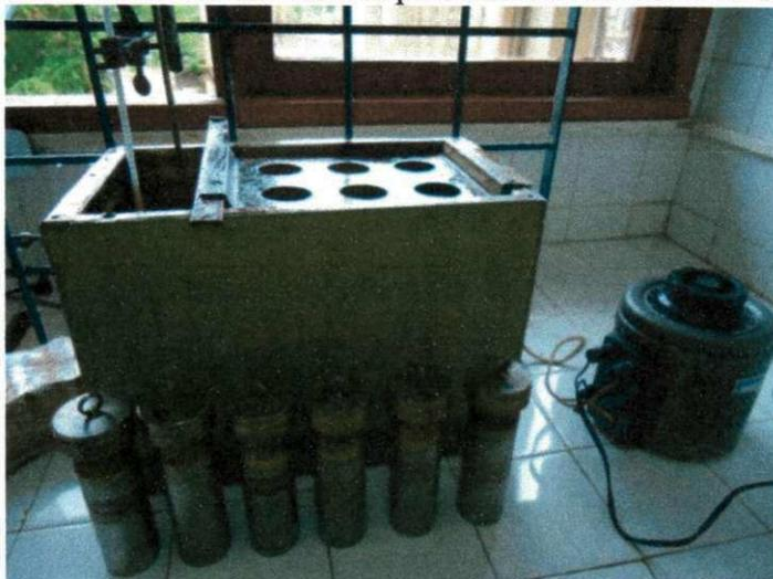
Cada reator foi carregado com 5,0 g de bagaço de caju seco e 50 mL de uma solução de  $H_2SO_4$  a 1%, proporção de solução ácida/bagaço (na ordem de 10:1) necessário para ocupar um volume no reator suficiente para não permitir uma grande variação na concentração da mistura hidrolisada.
