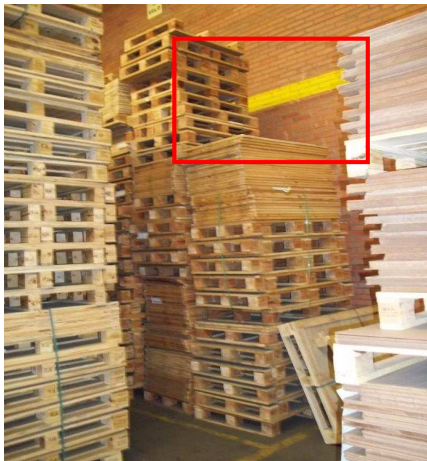
Figura 2 – Palete/tampa desativado ultrapassando margem de segurança.
