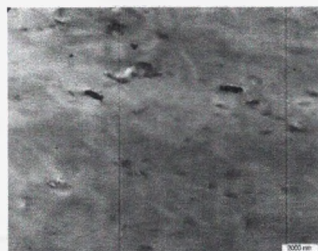
Figura 21: Fotomicrografias de MET do PP H503 com 3% de Brasgel ORG WB, 12Kg/h, R1 a 100 rpm.
