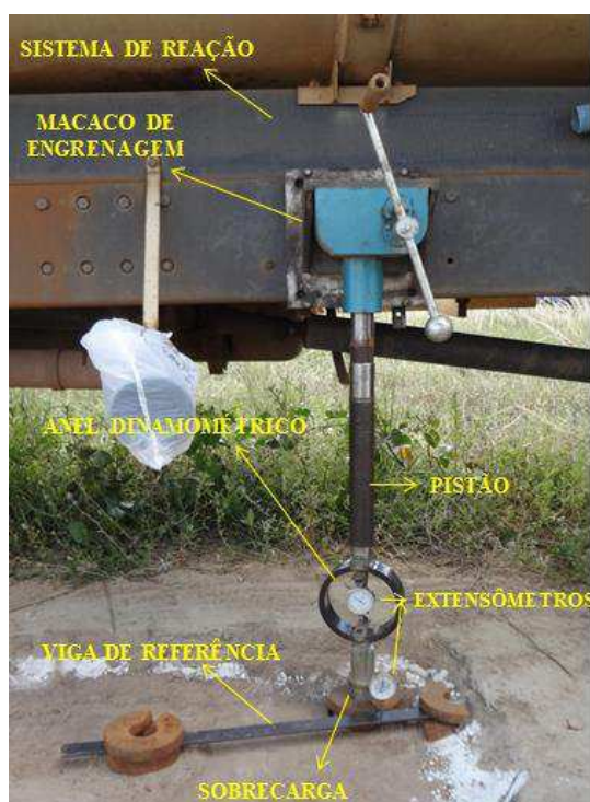
Figura 25- Equipamentos do ensaio CBR 'in situ'
