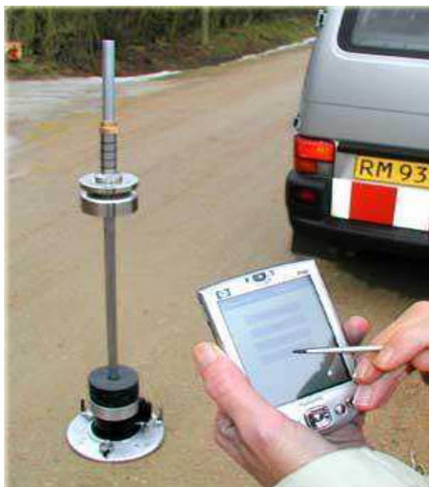
Figura 11- Equipamento LWD Dynatest 3031
