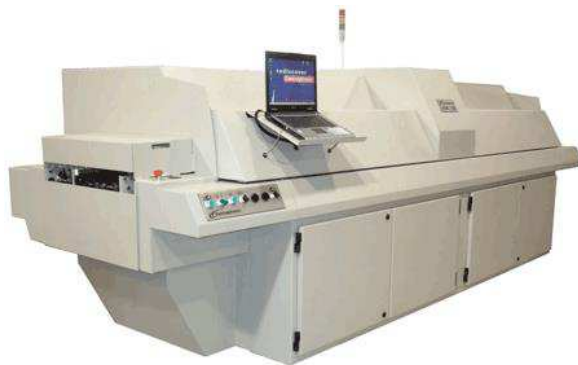
Figura 5 - Modelo de forno de refusão com 8 zonas de aquecimento
