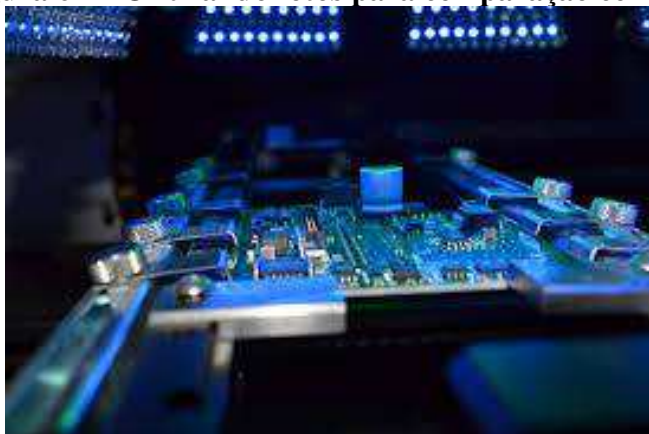
Figura 6 - AOI tirando fotos para comparação com programa
