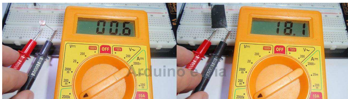
Imagem 3: Funcionamento do LDR.
