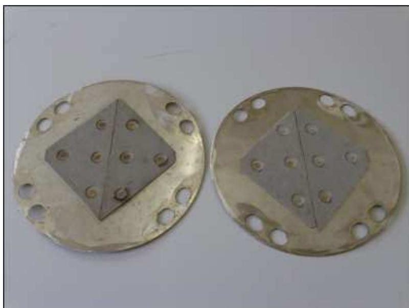
Logo após a montagem dos eletrodos o RM foi finalizado e em seguida acoplado no suporte de bancada. Ele também foi inclinado em 10° em relação a horizontal da mesma forma que o RR e foram utilizados polos iguais e solução de KOH como eletrólito.
