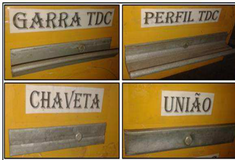
Figura 2 – Acessórios produzidos da reutilização do corte das chapas para fabricação de duto.
