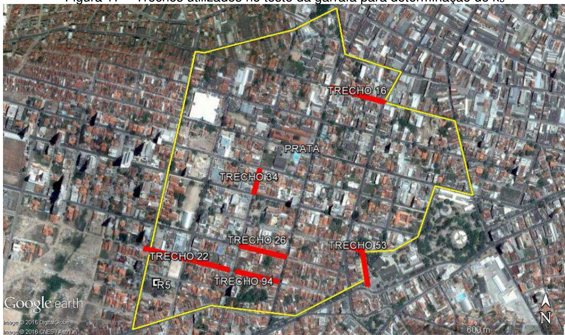
Figura 17 – Trechos utilizados no teste da garrafa para determinação de k_b
