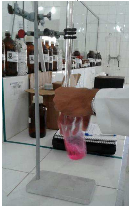
Figura 18 – Detalhe da execução do método DPD-SFA
