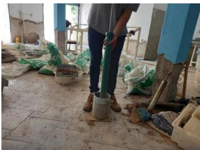
Figura 12- Compactação (Fonte: Terra Sol Engenharia Geotécnica,2021)
