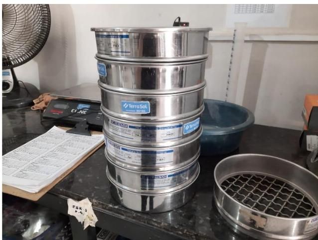
Figura 9 - Sequência de malhas. (Fonte: Terra Sol Engenharia Geotécnica,2021)
