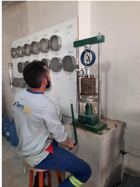
Figura 15- Rompimento dos corpos de prova (Fonte: Terra Sol Engenharia Geotécnica,2021)
