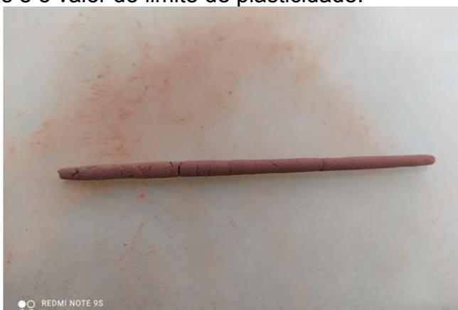
Figura 11- Limite de Plasticidade. (Fonte: Terra Sol Engenharia Geotécnica,2021)
