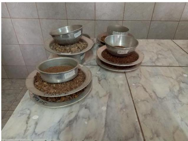
Figura 8 – Separação de amostras para secagem na estufa. (Fonte: Terra Sol Engenharia Geotécnica,2021)
