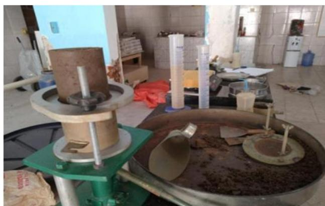
Figura 13- Amostra retirada do extrator. (Fonte: Terra Sol Engenharia Geotécnica,2021)
