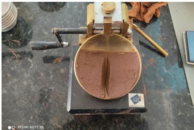
Figura 10- Limite de Liquidez. (Fonte: Terra Sol Engenharia Geotécnica,2021)
