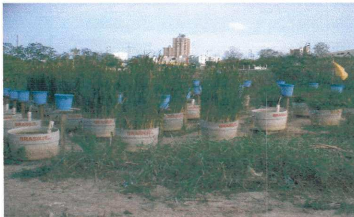
Figura 4.3 – Sistema de terras úmidas construídas no campo experimental da UFCG.
