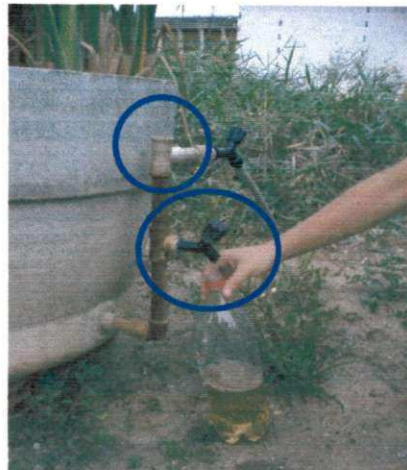
Figura 4.5 – Detalhes do tubo extravasor em uma TUC mostrando a torneira usada para coleta das amostras.
