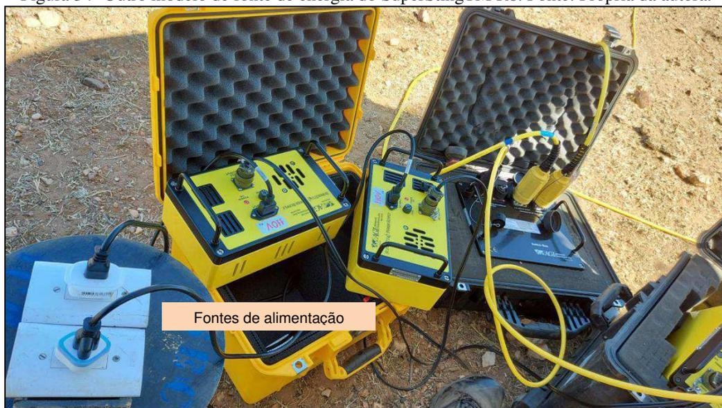
O resistivímetro é totalmente automatizado e apresenta alto nível de precisão com os menores níveis de ruídos, a extensão máxima da linha na superfície do terreno é de até 1 km, o que equivale a profundidade de investigações em subsolo variando de 200 a 250 metros, o que corresponde a 20% da extensão total da linha (Figura 33).
