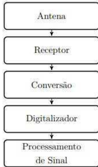
Figura 25 – Estrutura básica de um radiotelescópio comum. Fonte: Produção do autor.
