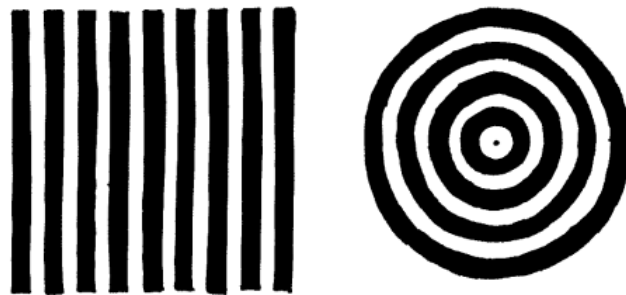
Figura 2 – Esquema para ilustrar a isotropia e homogeneidade. Fonte:[1]
