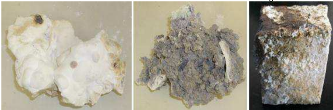
Foto 8 – Amostras do revestimento refratário coletadas na região da falha
