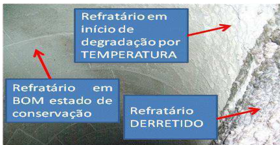
Foto 4 – Danos ao refratário na região do combustor
