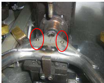
Figura 2 – “GAP” entre o tubo e o suporte central
