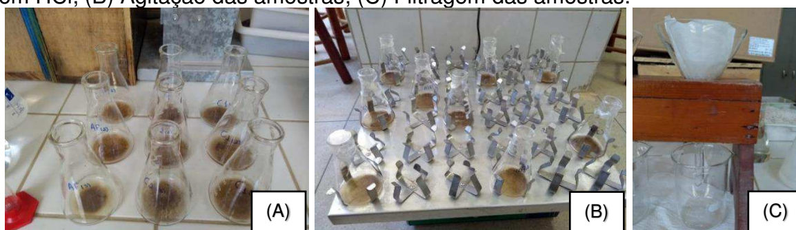
Figura 12 - Preparação das amostras para análise de metais: (A) Amostras de solo com HCl; (B) Agitação das amostras; (C) Filtragem das amostras.
