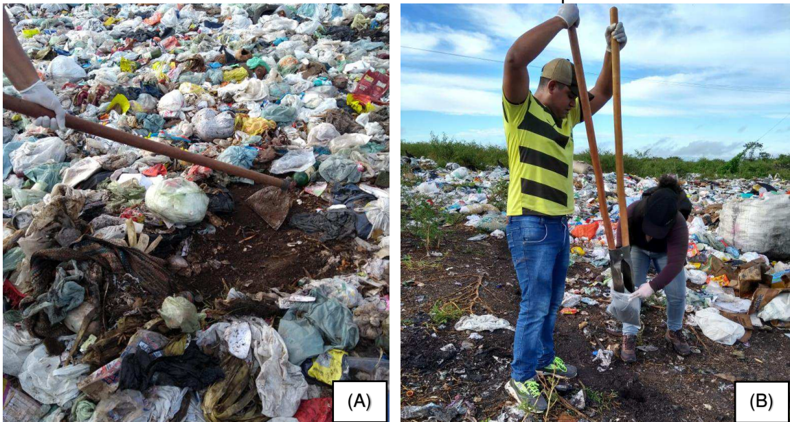
Figura 7 - Coleta do solo da área de lixão: (A) Limpeza da área para coleta; (B) Coleta da amostra com trado holandês e armazenamento em saco plástico
