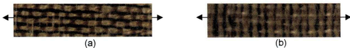
FIGURA 2 : Corpos de prova para ensaio de tração: (a) ensaio na direção das fibras de juta; (b) ensaio na direção das fibras de vidro.
