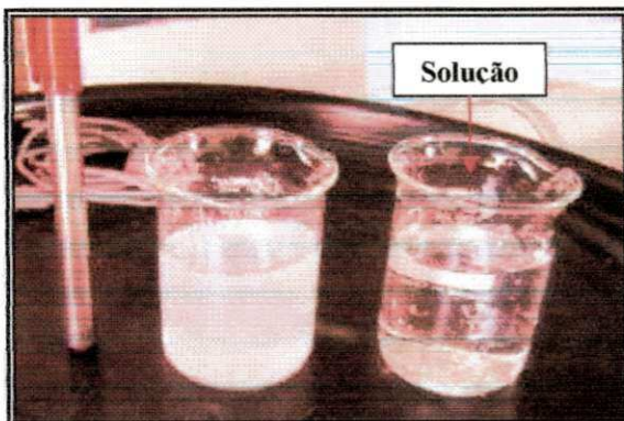
Figura 32. Efluente de limpeza química após extração de sais e solução de limpeza.
