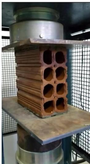
Figura 24 – Bloco na prensa (Fonte: Autor; 2023)
