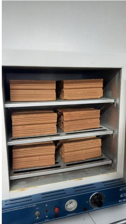
Figura 15- Blocos cerâmicos em estufa (Fonte: Autor; 2023)
