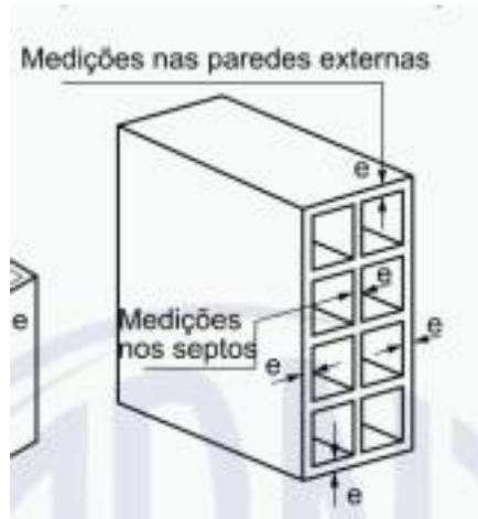
Figura 11 – Pontos a serem medidos para determinação dos septos (Fonte: ABNT NBR 15270-2, 2017)
