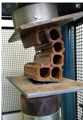
Figura 25- Bloco após a ruptura (Fonte: Autor; 2023)
