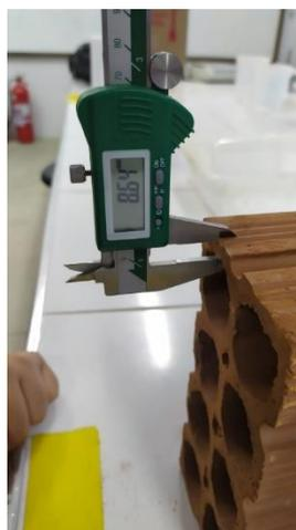
Figura 13 – Medida dos septos e paredes externas (Fonte: Autor; 2023)
