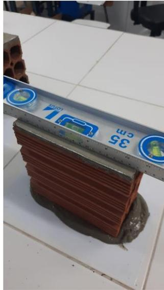
Figura 20 – Nivelamento dos blocos (Fonte: Autor; 2023)
