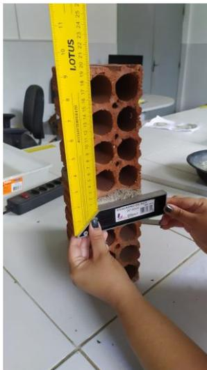
Figura 23 – Medida da junta de assentamento (Fonte: Autor; 2023)
