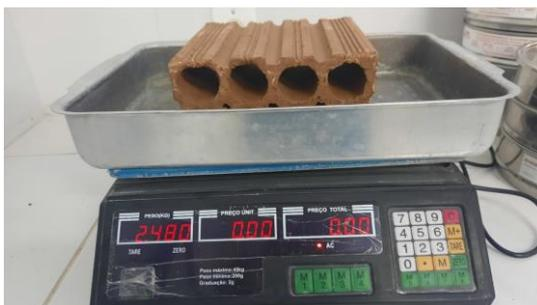
Figura 14 – Pesagem dos blocos (Fonte: Autor; 2023)
