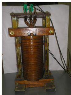
Fig. 01 Transformador Monofásico
