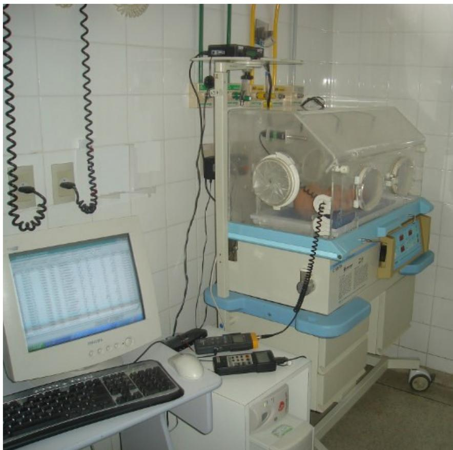
**Figura 12: Sistema de aquisição de dados com controle de umidade.**
