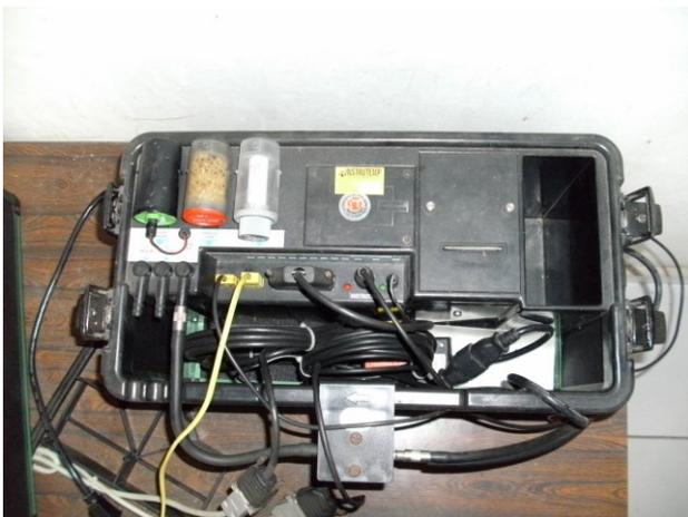
Figura 4 – Analisador de gases
