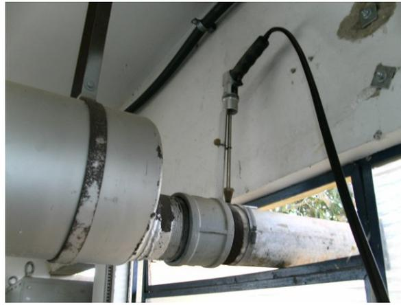
Figura 6 – Sonda do analisador de gases
