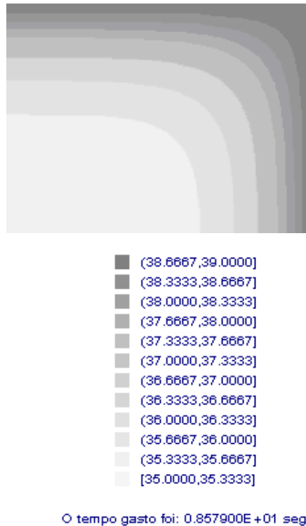
Figura 7 – Gráfico de contorno com a distribuição de temperatura para o Paralelepípedo A .
