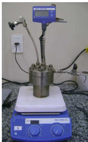
Figura 3.2 - Representação esquemática da montagem do sistema realizado para o acompanhamento cinético.
