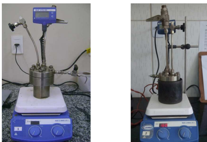
Figura 3.1 - Reator de aço inox utilizado no processo de síntese de biodiesel. Sistema reator e placa de aquecimento com agitação.
