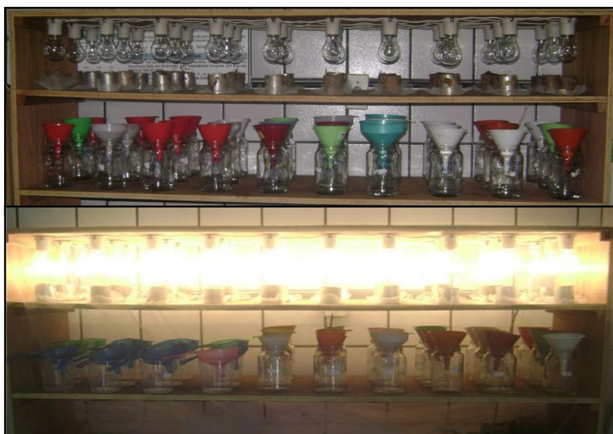
Figura 3. Equipamento Berlese-Tullgren modificado
