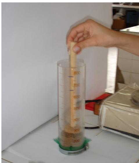
Figura 1. Montagem de uma coluna de lixiviação
