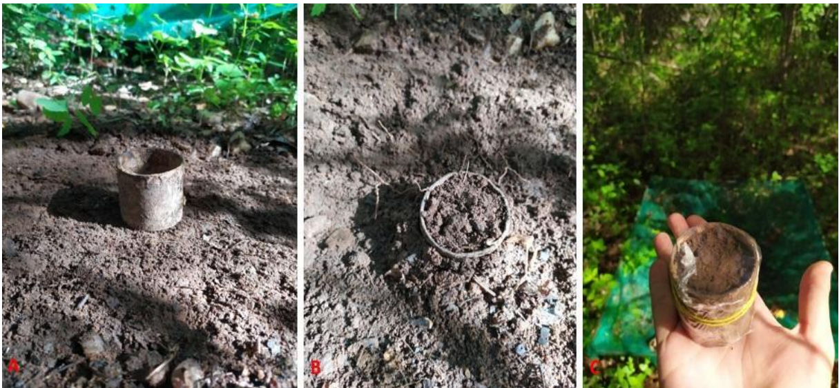
Figura 8 – Anéis metálicos utilizados na coleta de amostras de solo para extração da mesofauna.
