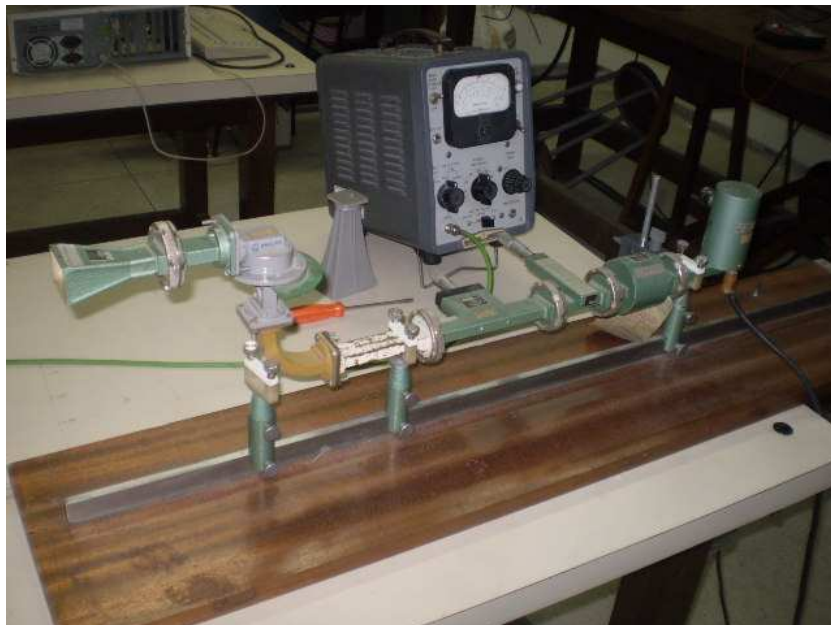
Figura 5.13: Montagem para a medição do diagrama de potência irradiada
