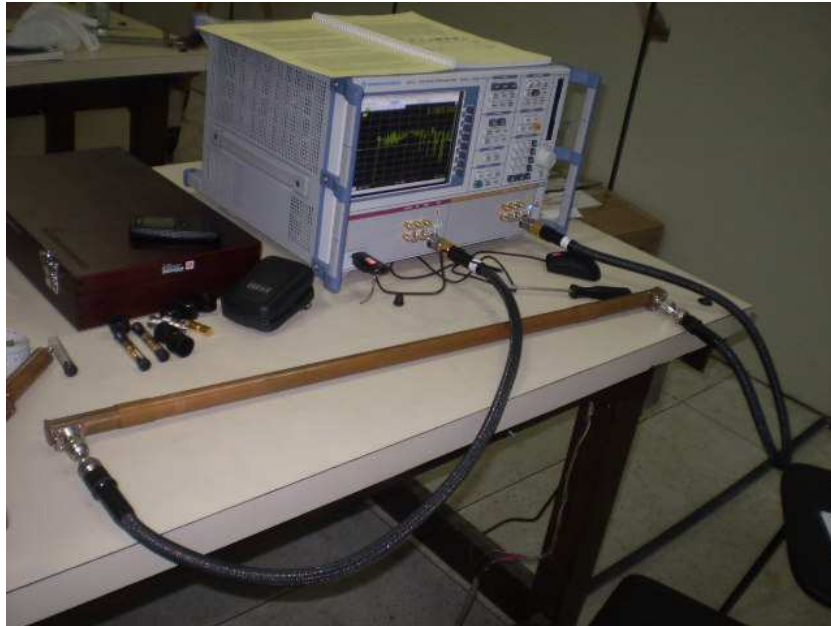
Figura 5.10: Montagem para a aferição das características de propagação do guia de ondas circular construída.
