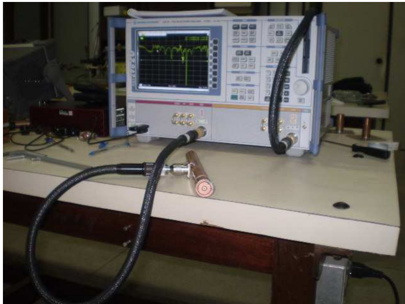
Figura 5.11: Aferição do parâmetro de espalhamento da antena.
