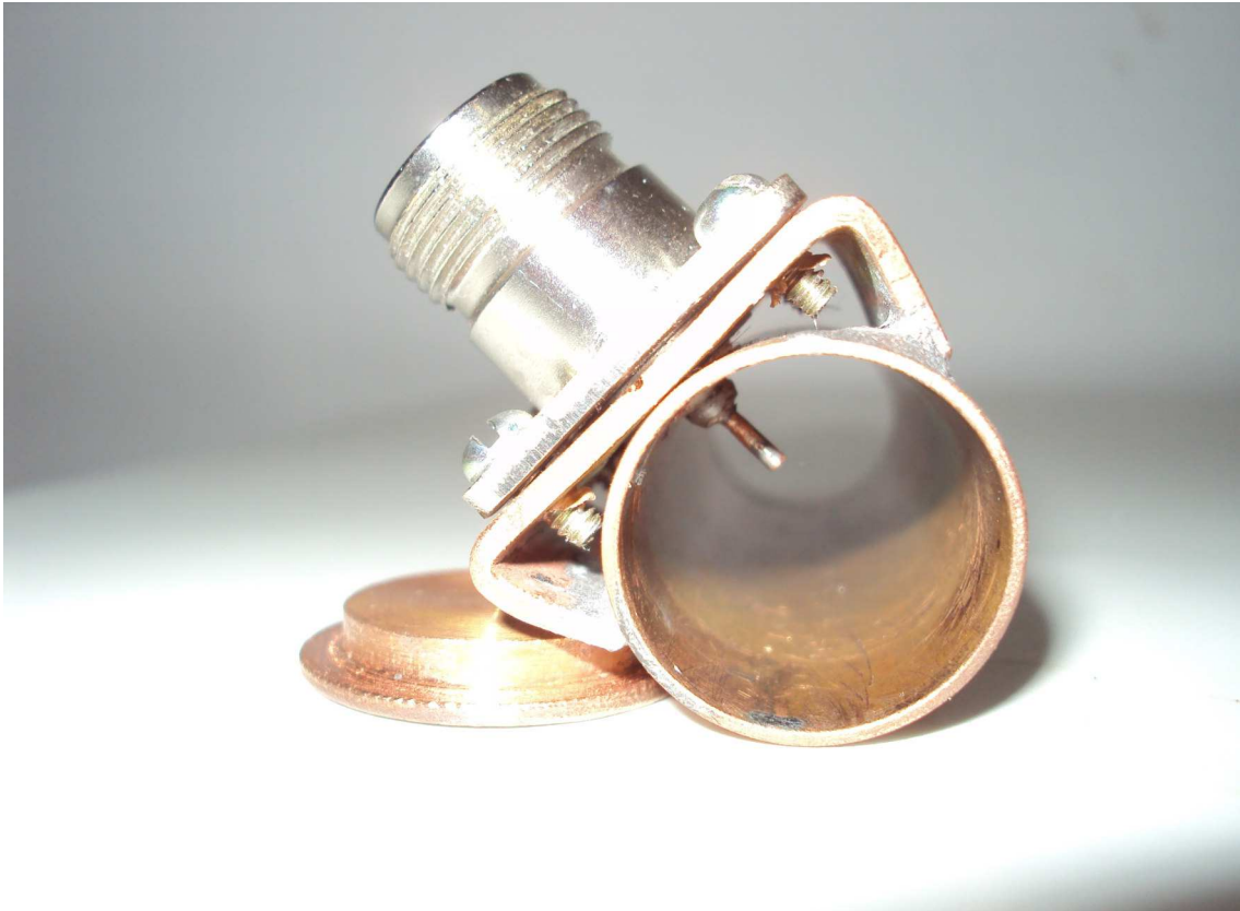
Figura 5.5: Detalhe da ponta de prova
