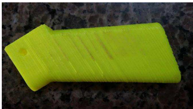
Figura 4 - Modelo exemplo impresso antes do tratamento por vapor de acetona
