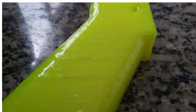
Figura 5 – Modelo exemplo depois do tratamento com vapor de acetona
