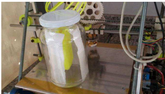
Figura 3 – Processo de tratamento superficial do ABS
