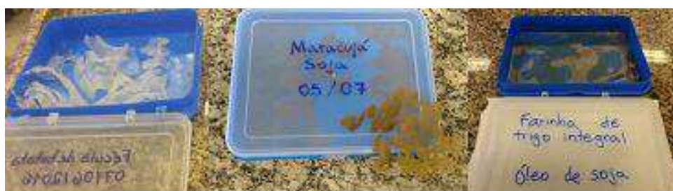
Figura 2 – Bioplásticos feitos a partir de fécula de batata/farina de maracujá/farina de trigo integral e óleo de soja
