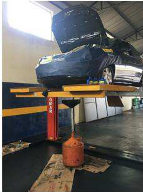
Figura 4 - Utilização do papelão como forro de piso
