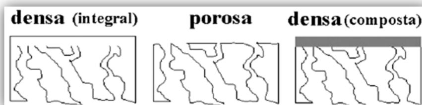
Figura 3 - Ilustração da estrutura das membranas anisotrópicas.
