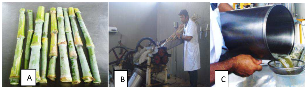
Figura 3.2. A) Colmo de sorgo limpo, B) Extração do caldo, C) Caldo filtrado
