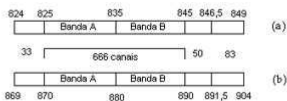
Figura 2.5: Canais utilizados na telefonia móvel celular analógica exibidos separadamente para comunicação: (a) Sentido Celular => ERB e (b) Sentido ERB => Celular
