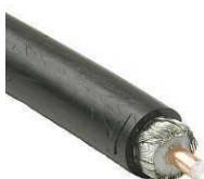
Figura 5.3: Cabo RGC 213 utilizado na ERB e nas conexões das antenas clientes. Possui perda de 25,2dB/100m na faixa de frequência de 2400 - 2500 MHz
