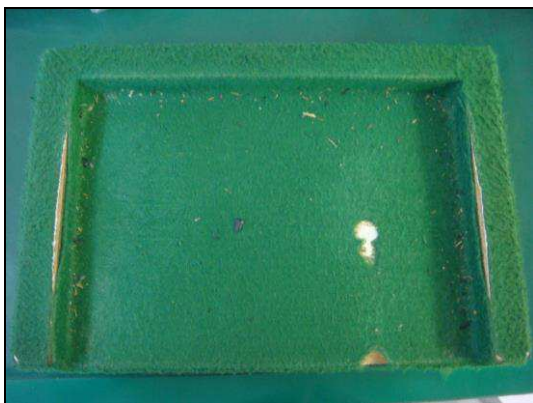
Figura 10: Manta desgastada (antes)
