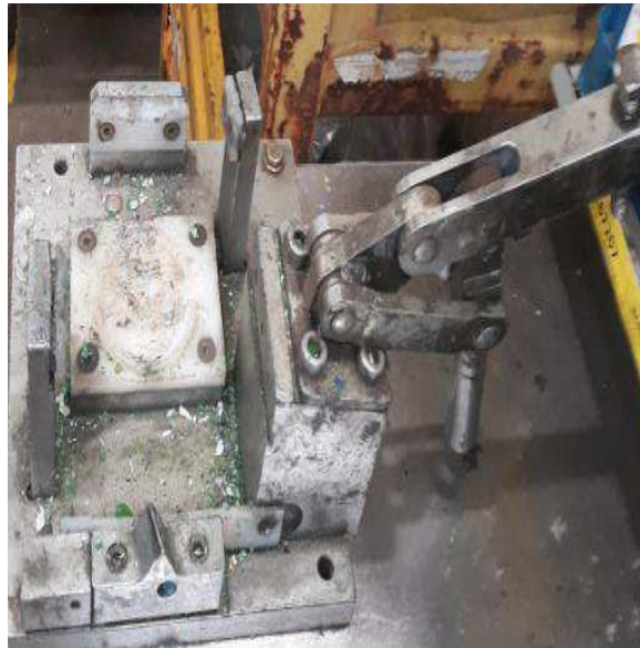
Figura 3 – Dispositivo com base em formato U
