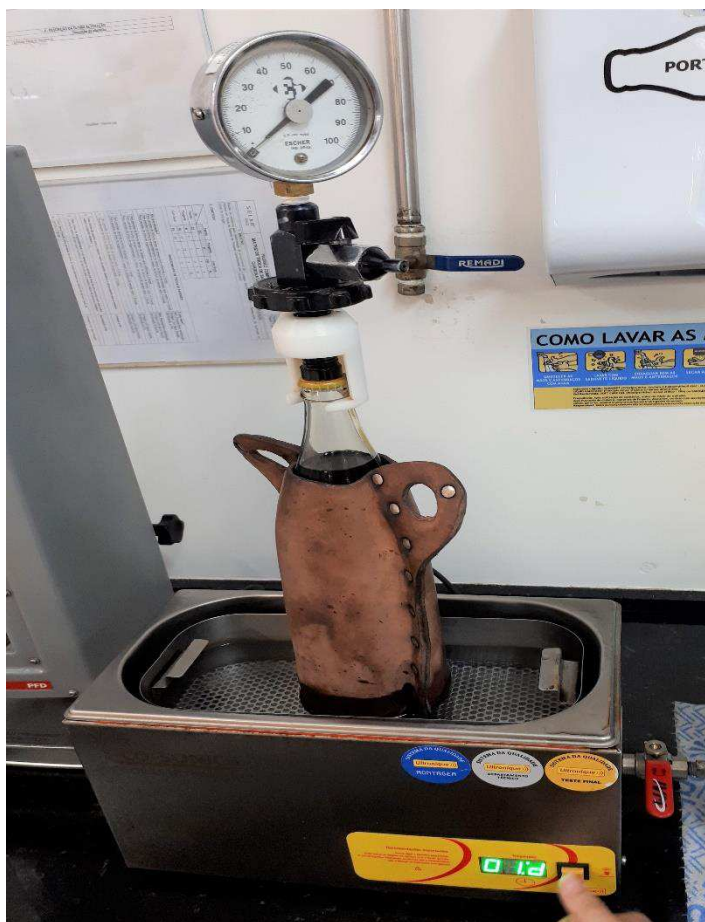
Figura 4 – Montagem de material para análise de CO 2
