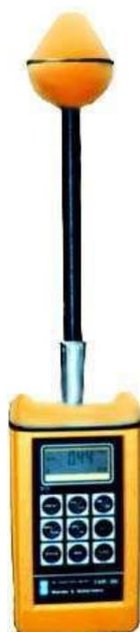
Figura 6.9: Medidor de campo EMR-300 da Wandel & Goltermann .
