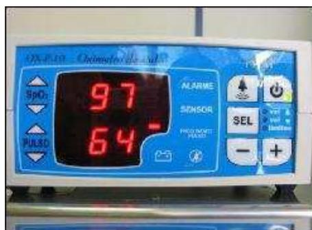
Figura 4.4: Oxímetro padrão indicador da pulsação sanguínea e da concentração de oxigênio no sangue.
