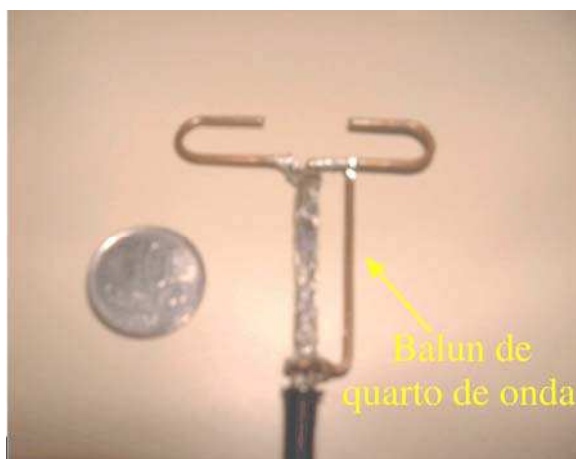
Figura 42 - Protótipo da antena dipolo curvado com Balun de quarto de onda.
