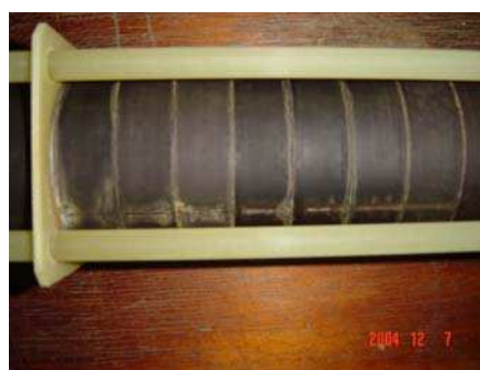
Fig. 36 - Marca de descarga elétrica.
