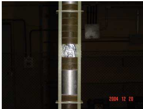
Fig. 56 - Varistores subsequentes sob curto-circuito.
