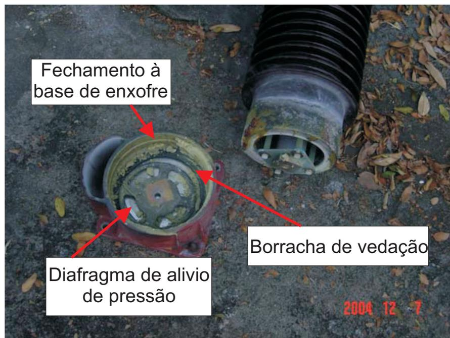
**Figura 2.6** – Para-raios após abertura da flange.
