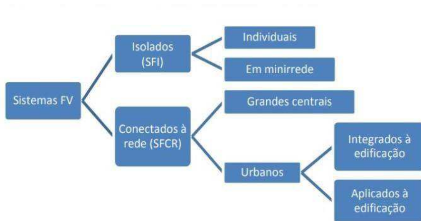
Figura 2 - Tipos de Sistemas Fotovoltaicos
