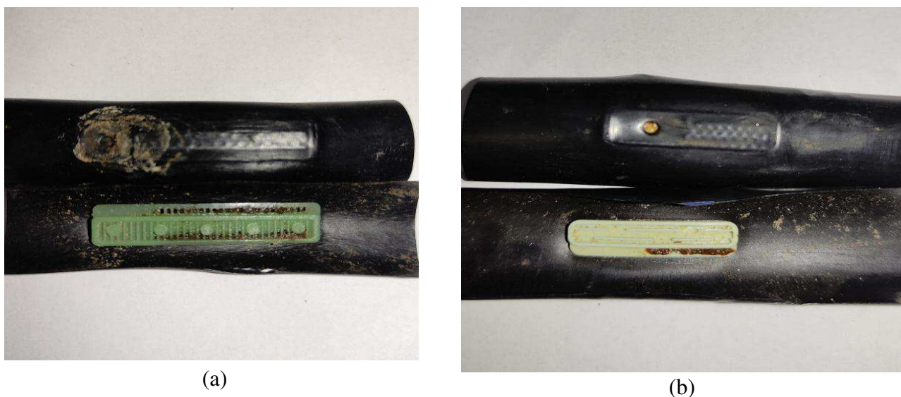
Figura 16. (a) Fita gotejadora Tiquira (FT); (b) Fita gotejadora AZUD Sprint (FS) após 576h de funcionamento com água de abastecimento urbano.
